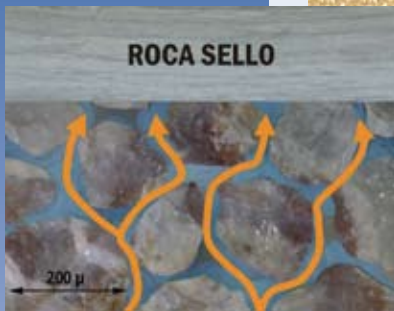
Figura 1 El CO 2 , que es más ligero que el agua, tiende a ascender hasta quedar detenido por las capas de rocas impermeables superiores.
