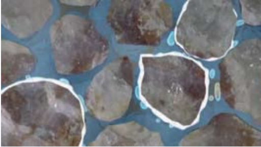
Figura 2 CO 2 denso migrando hacia arriba (burbujas azul claro) disolviéndose y reaccionando con los granos de la roca, lo cual lleva a la precipitación de minerales carbonatados en los bordes de grano (color blanco).
