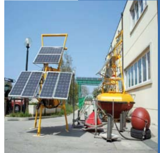
Figura 2 Boya de monitorización con paneles solares como fuente energética, flotadores y dispositivo de muestreo de gas en el fondo marino.
