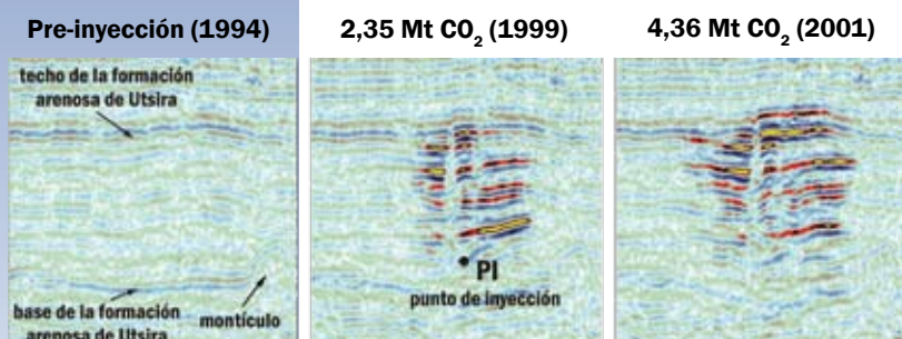
Figura 1 Representación digital de monitorización de la pluma de CO 2 en Steipner antes de la inyección (que comenzó en 1996) y tras la inyección (3 y 5 años después, respectivamente).
